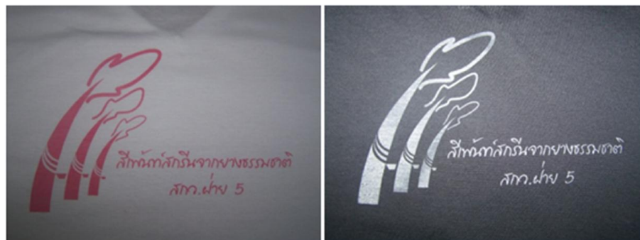
ภาพ 5 การใช้งานจริงของสีเพ้นท์สกรีนจากน้ำยางธรรมชาติ
