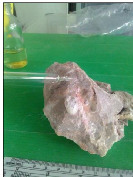
ภาพ 2 การทดสอบชนิดของหินโดยใช้กรด HCl 10% และการหาปริมาตรของหินโดยใช้หลักการการแทนที่ของน้ำ
