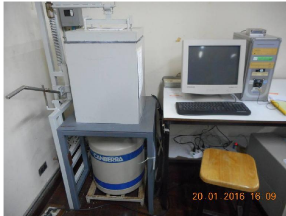
ภาพ 3 ชุดระบบหัววัดรังสีแกมมา ชนิดหัววัดแบบ HPGe ณ ห้องปฏิบัติการหน่วยวิจัยธรณีฟิสิกส์ มหาวิทยาลัยสงขลานครินทร์
