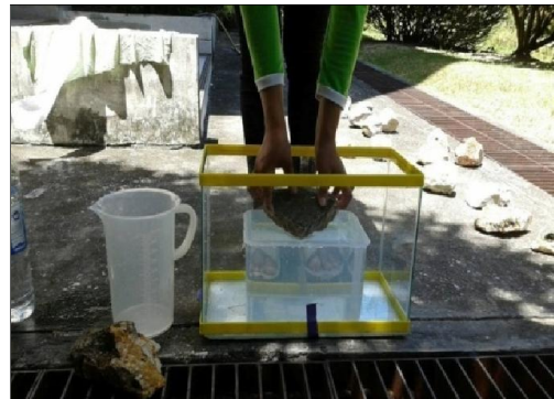
ภาพ 2 การทดสอบชนิดของหินโดยใช้กรด HCl 10% และการหาปริมาตรของหินโดยใช้หลักการการแทนที่ของน้ำ
