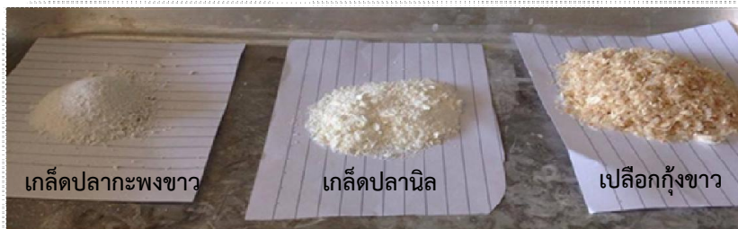
ภาพ 4 ลักษณะโคโตซานจากเกล็ดปลากะพงขาว เกล็ดปลานิล และเปลือกกุ้งขาว
